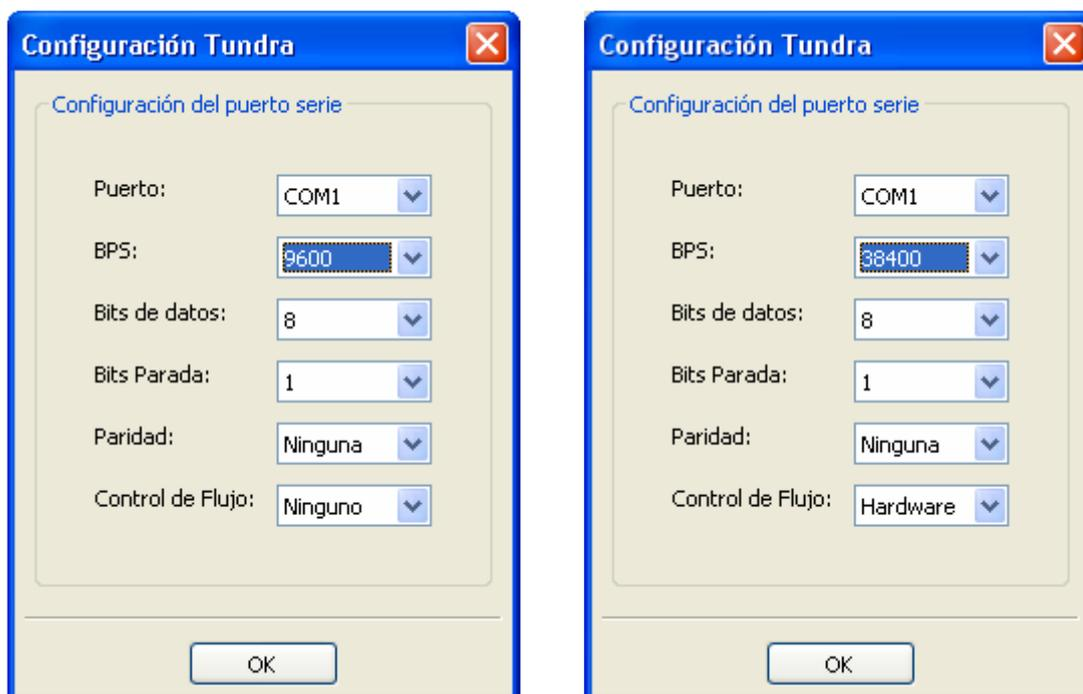
Si la comunicación habitual con su Estación Meteorológica se realiza mediante Amplificador RS232, la velocidad, será de 9600 Bps. Si su comunicación habitual por USB, GSM, GPRS, Ethernet, o Wifi, la velocidad de conexión será de 38400 Bps.
