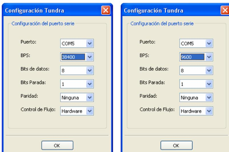
Utilizar solo BPS a 9600 si su Estación Meteorológica se ha solicitado para comunicar habitualmente con RS232 amplificado (aunque en este momento se conecte por USB). Para comunicación con USB, GSM, Ethernet, Wifi y GPRS indique comunicación a 38400.
